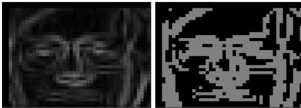
Slika 3. Rezultat Sobelovega operatorja nad sliko 2 levo (levo) in binarizacija Sobelove slike (desno). Figure 3. Result of the Sobel operator of Figure 2 left (left) and binarized Sobel image (right).
